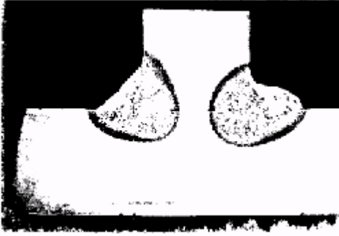
Şekil 5.16. 25 mm kalınlığındaki saçta içköşe dikişlerinin formu. Ark gerilimi: 42 V, kaynak akımı: 650 A; kaynak hızı: 250 mm/dak; koruyucu gaz: CO 2 .
