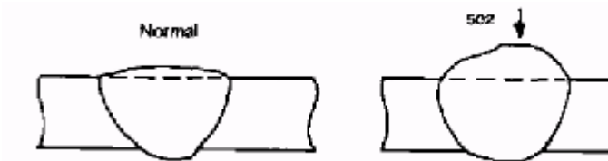
Şekil 14.25.-Normal ve aşırı metal yığılması (şematik).
