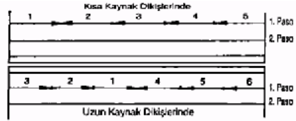
Şekil 4.14.- Kaynak dikişlerinde adım yönteminin uygulanışı.
