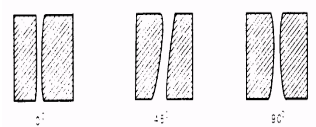
Şekil 5.13. Polarizasyon şeklinin yarık profiline etkisi.
