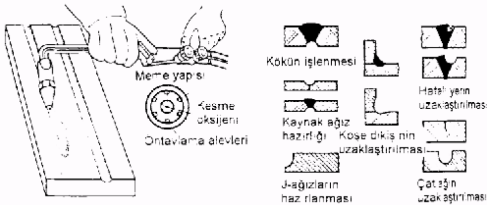
Şekil 2.38. Oksijenle oyuk açma işleminin tipik uygulama alanları.
