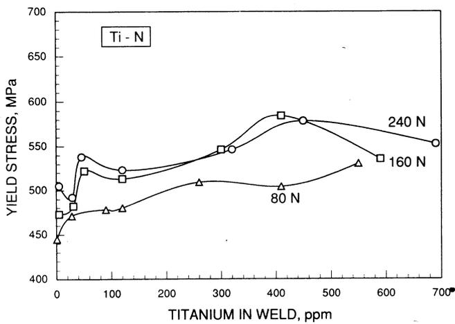
FIG. 5 YIELD STRENGTH OF THE Ti-N WELD SYSTEM PLOTTED AGAINST TITANIUM CONTENT
