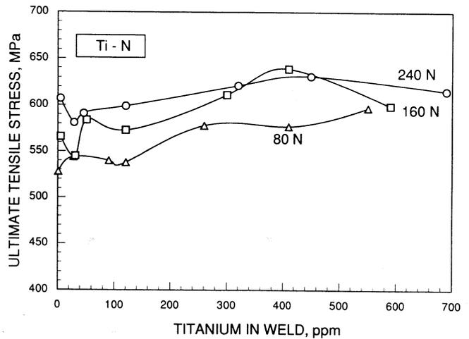
FIG. 6 ULTIMATE TENSILE STRENGTH OF THE Ti-N WELD SYSTEM PLOTTED AGAINST TITANIUM CONTENT
