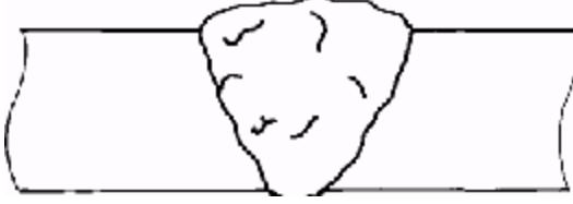
Şekil 95 — Dikiş içinde kalıntılar (şematik).
