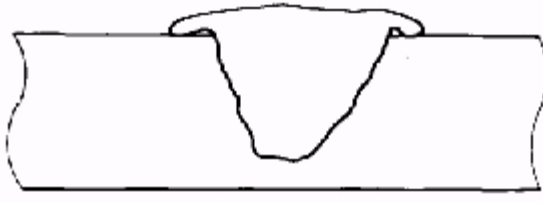
Şekil 97 — Kaynak dikişinde taşma (şematik).
